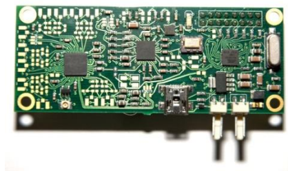
Oscilador externo de 52 Mhz "Clocktamer".
