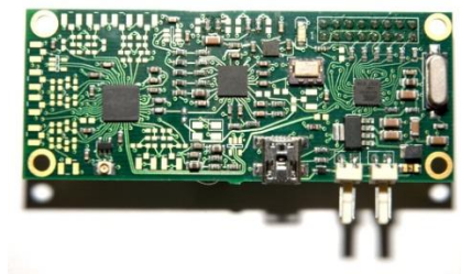
Oscilador externo de 52 Mhz "Clocktamer".
