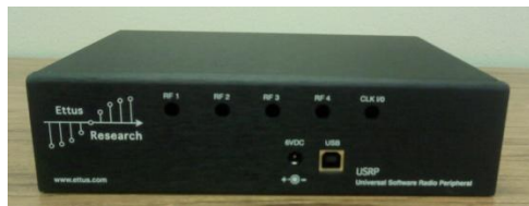
Vista frontal de la unidad usrp1 sin antenas.
